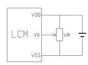
$V_{\text{DD}\sim}V_0$ : LCD Driving voltage
