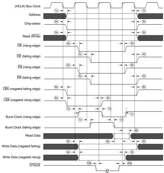
Figure 53. EIM Bus Timing Diagram
