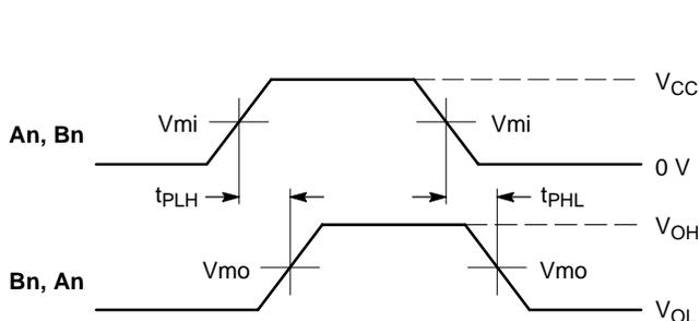
**WAVEFORM 1 – PROPAGATION DELAYS**
